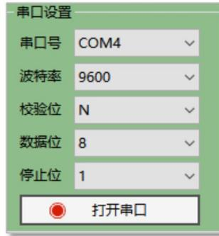
注意：如果在“基本参数”设置模块中重新设置了通信速率，应按照设置的波特率通信。
