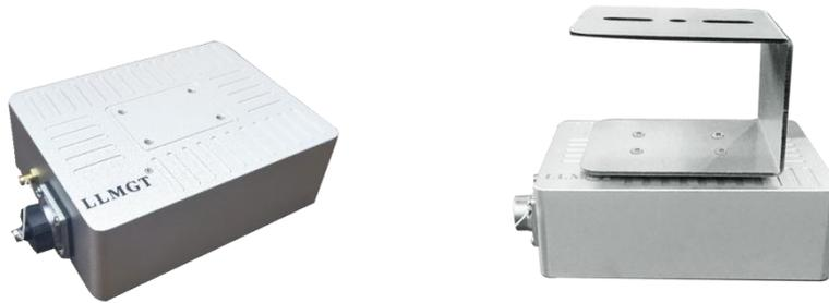
MGTR-S-R 系列雷达水位计，采用 77GHz 线性调频连续波（FMCW）体制，通过对发射信号和回波信号相参接收，形成与距离成比例关系的差频信号，采用信号处理和高精度频谱估计等技术手段来实现液位的高精度测量。产品频带范围为 77GHz 至 81GHz，具有高达 4GHz 的连续带宽。
